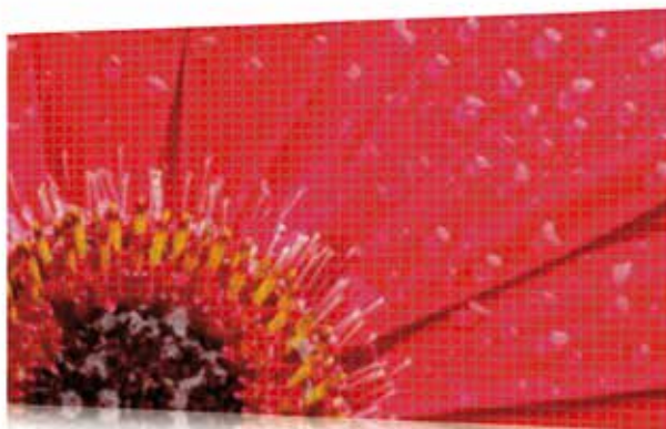
Typické rušivé mřížkování (screen door effect) u projektorů bez technologie SXRD.
